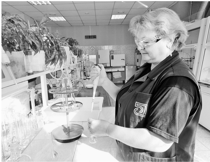
Лаборант хим.анализа 5-го разряда С.А. Суханова определяет концентрацию СПАВ
