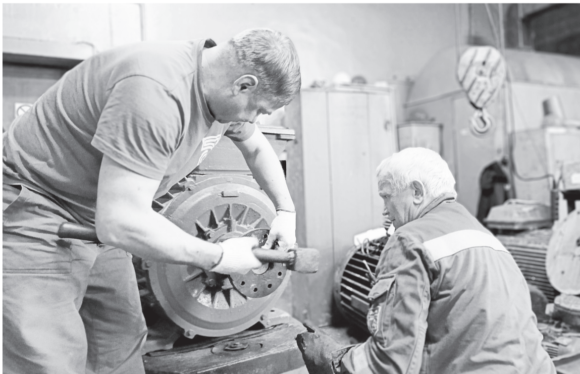
Электромонтёры по ремонту и обслуживанию электрооборудования БП №2 А.Н. Грибанов и В.Н. Капустин надевают полумуфту на двигатель в электромастерской производства
