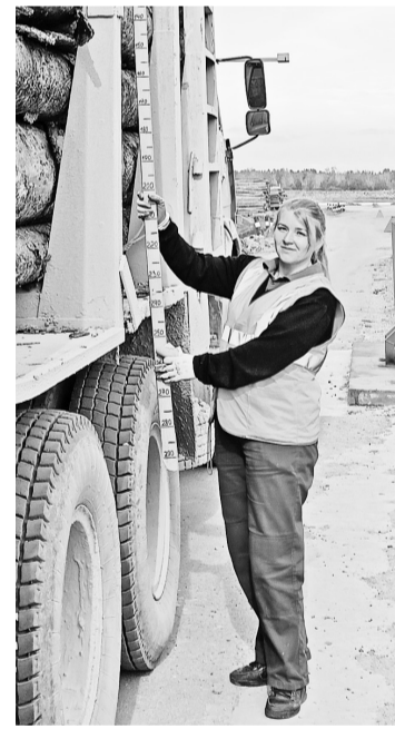
Контролёр ЦБП Н.И. Лыткина дублирует геометрическим методом замер системы «СканТрек»
