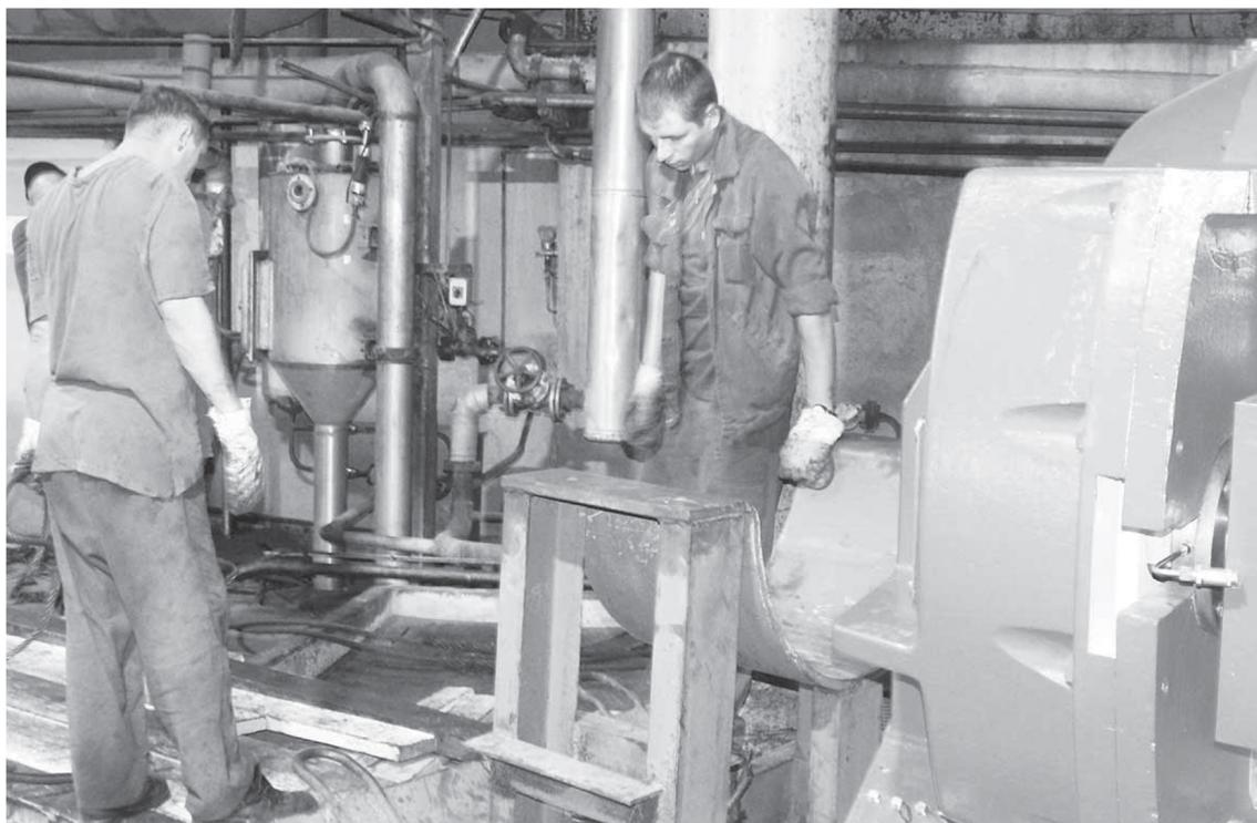
Слесари цеха централизованного ремонта монтируют новые узлы рафинёра.
