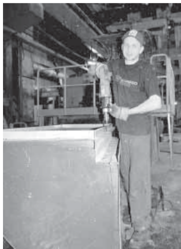
Замена воздуховодов вытяжки с зультуров. Сергей Хвостанцев за работой.
