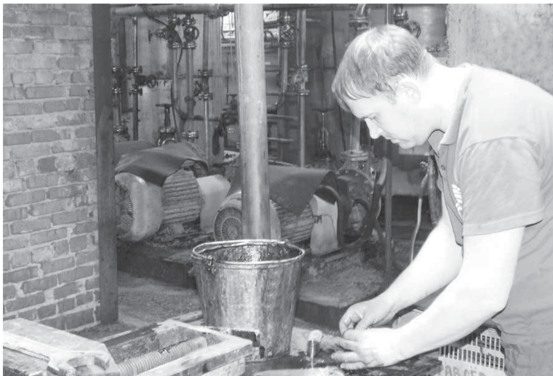
Сушильщик Евгений Владимирович Волков промывает мазутную форсунку. Оборудование должно быть чистым.
