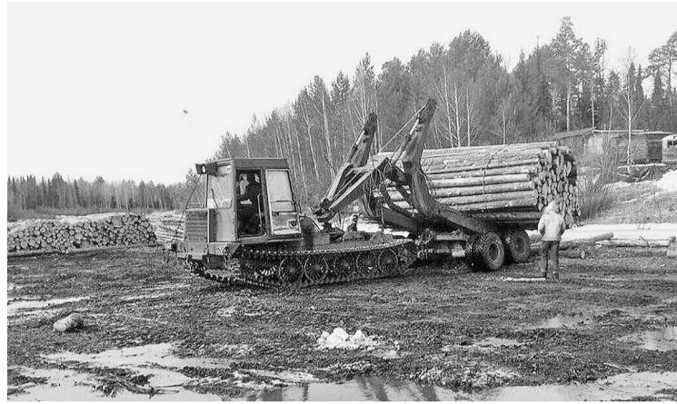
Формирование плота сплоточным агрегатом
