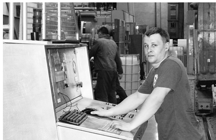
Сушильщик БДМ 5 разряда А.А. Чистин контролирует режим работы БДМ №1 с операторской станции
