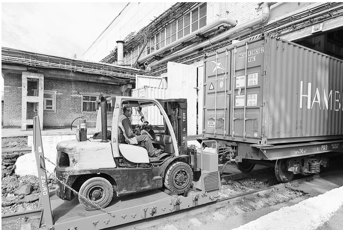
Маневровое устройство — бесприводная пятиосная тележка. Перемещение маневрового устройства осуществляется автопогрузчиком, въезжающим на его платформу
