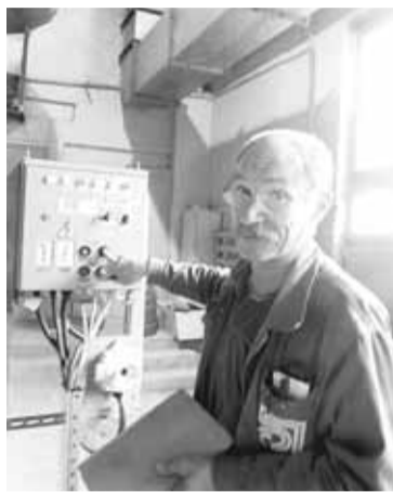
Вадим Георгиевич Якимов, бригадир бригады литейщиков показывает панель управления автоматизированной индукционной печи.
